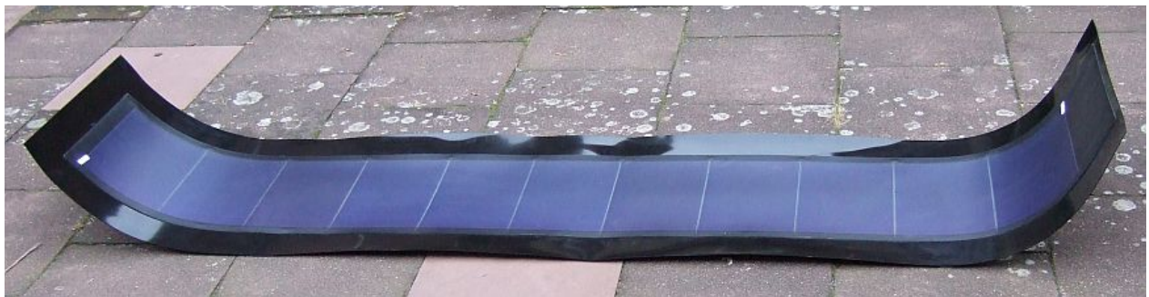
Abb. 1: Flexibler Dünnschicht-Solarmodulstreifen im Verbund mit KDB
